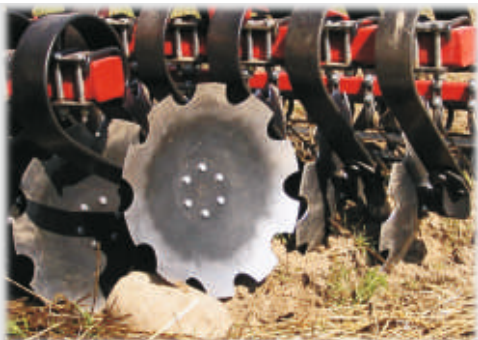
Indywidualne sprężyny zabezpieczają talerze przed uszkodzeniem oraz powodują lepsze zagłębienie się talerzy.
